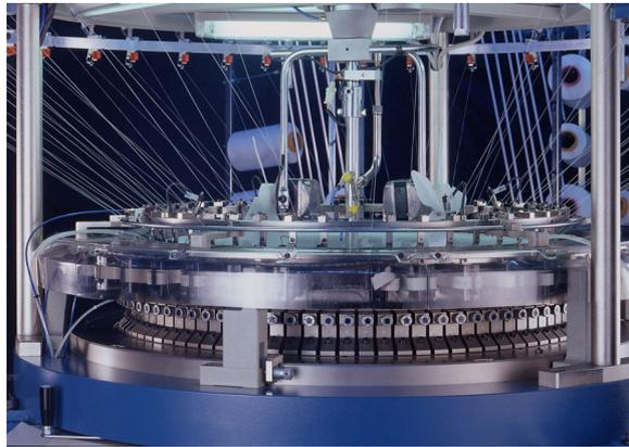
Tradizionale basamento Orizio modulare, rinnovato nella funzionalità, robustezza ed estetica, con nuovo pannello di controllo "Oritec" che permette la fruizione di nuove tecnologie ed ingloba in un'unica cabina elettronica la selezione degli aghi e le seguenti funzioni:
