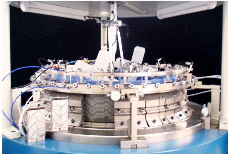
Tradizionale basamento Orizio modulare, rinnovato nella funzionalità, robustezza ed estetica con nuovo pannello di controllo "Oritec" che permette la fruizione di nuove tecnologie ed integra in un'unica cabina le seguenti funzioni:
