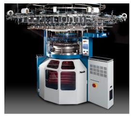
Tradizionale basamento Orizio modulare, rinnovato nella funzionalità, robustezza ed estetica, con nuovo pannello di controllo "Oritec" che permette la fruizione di nuove tecnologie ed ingloba in un'unica scheda elettronica le seguenti funzioni:
