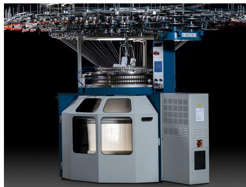
Tradizionale basamento Orizio modulare, rinnovato nella funzionalità, robustezza ed estetica, con nuovo pannello di controllo "Oritec" che permette la fruizione di nuove tecnologie ed ingloba in un'unica scheda elettronica le seguenti funzioni:
