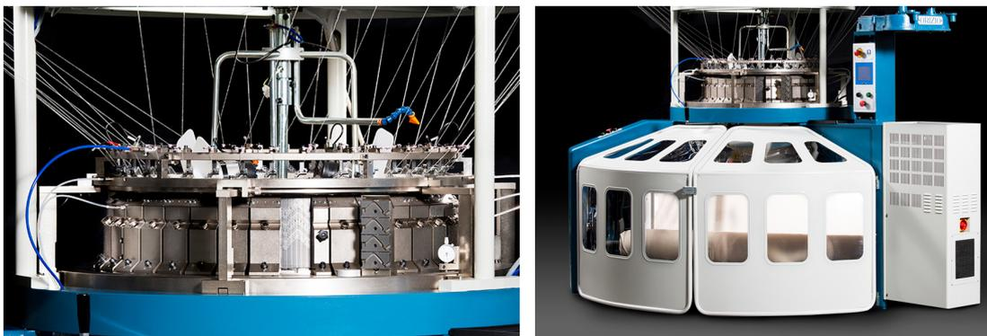
Tradizionale basamento Orizio modulare, rinnovato nella funzionalità, robustezza ed estetica, con nuovo pannello di controllo "Oritec" che permette la fruizione di nuove tecnologie ed ingloba in un'unica scheda elettronica le seguenti funzioni:
