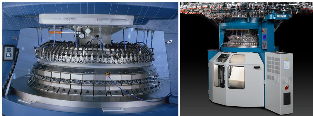
Tradizionale basamento Orizio modulare, rinnovato nella funzionalità, robustezza ed estetica con nuovo pannello di controllo "Oritec" che permette la fruizione di nuove tecnologie ed ingloba in un'unica scheda elettronica le seguenti funzioni:
