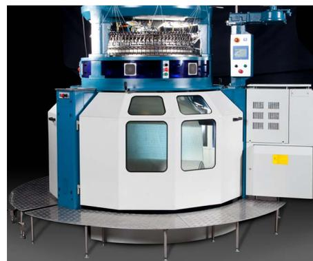
Tradizionale basamento Orizio modulare, rinnovato nella funzionalità, robustezza ed estetica con nuovo pannello di controllo "Oritec" che permette la fruizione di nuove tecnologie ed ingloba in un'unica scheda elettronica le seguenti funzioni:
