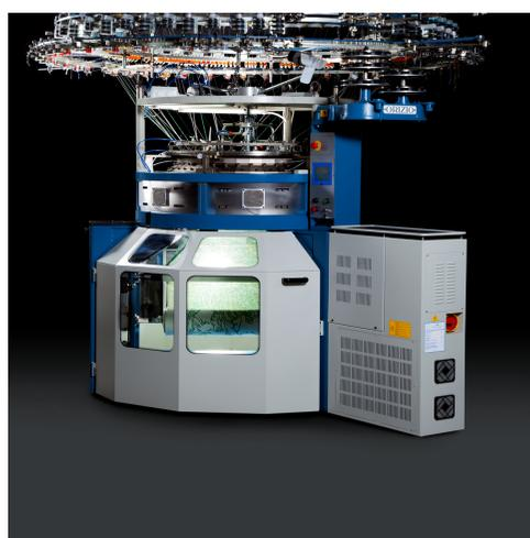
Tradizionale basamento Orizio modulare, rinnovato nella funzionalità, robustezza ed estetica, con nuovo pannello di controllo che permette la fruizione di nuove tecnologie ed ingloba in un'unica cabina il controllo della macchina, la selezione degli aghi e le seguenti funzioni:
