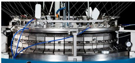
Tradizionale basamento Orizio modulare, rinnovato nella funzionalità, robustezza ed estetica, con nuovo pannello di controllo 'Oritec' che permette la fruizione di nuove tecnologie ed ingloba in un'unica cabina il controllo macchina, la selezione degli aghi e le seguenti funzioni:
